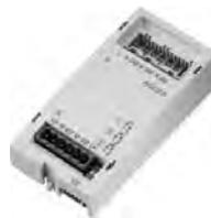
**AGU 2.550.** Interface control de una zona de baja temperatura y hasta 3 de alta temperatura y sistemas solares. Gestión remota de caldera con señal 0-10 V y control de recirculación sanitaria. Ubicación interna en la placa electrónica de la caldera.
